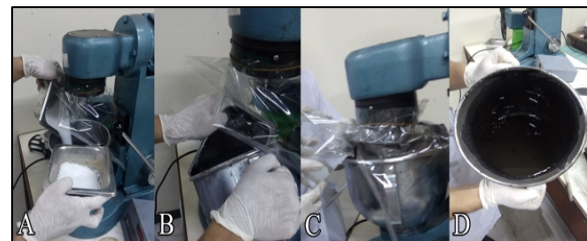
Fig. 2 The dry mix method: (A) dry alkali activators, (B) fly ash, (C) water, (D) geopolymer paste.
