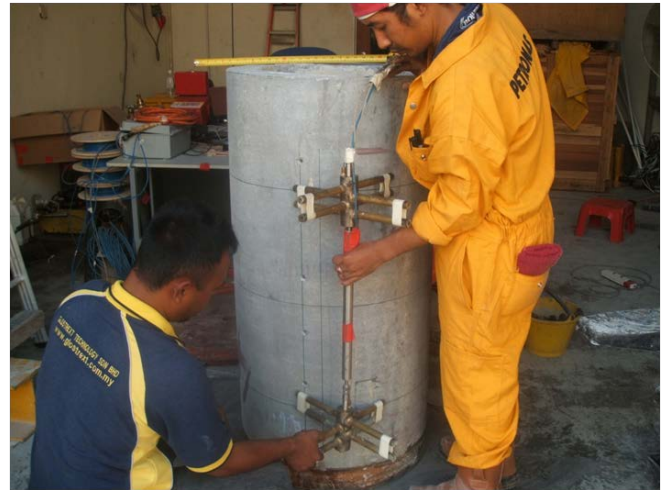
Fig. 3 (d) Actual Global Strain Extensometer system for spun pile application
